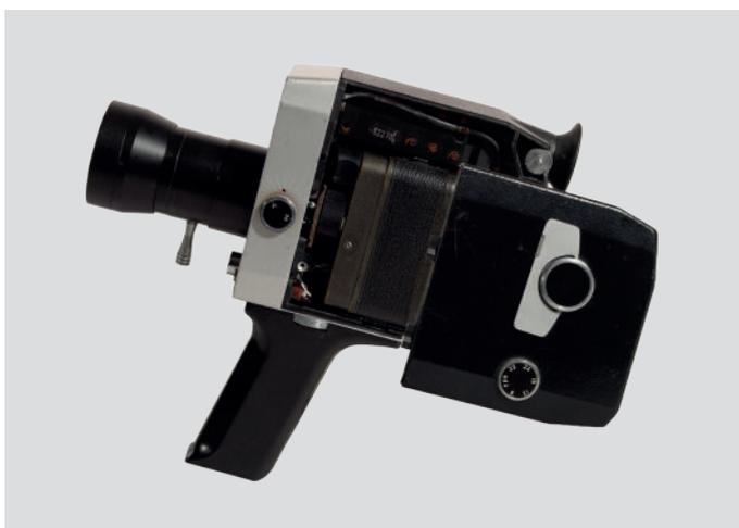
Camera KMZ « Quartz » 1x8 S-2 modifiée par le KGB (URSS), avec un appareil photo F-22 « NAILON » caché à l'intérieur et permettant la prise de photo clandestine à un angle de 90°.
