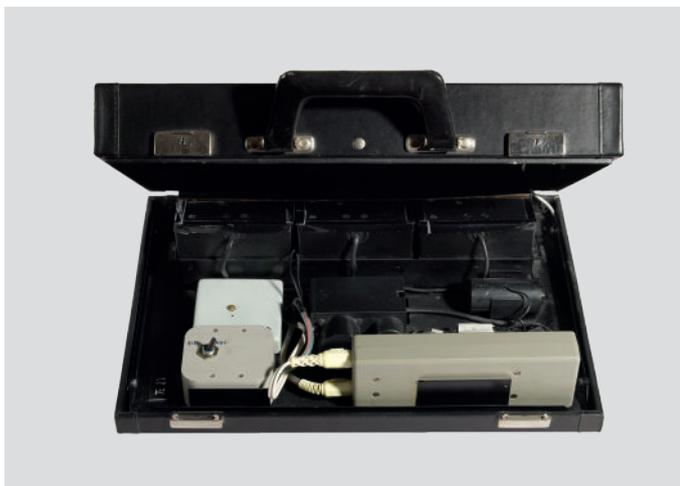
**Valise de la STASI (RDA) équipée d'un appareil photo PENTACON HFK I (« Halb Format Kamera » I) pour réaliser des photographies clandestines infrarouges, vers 1987.** L'appareil est accompagné de sa notice dans une enveloppe de la STASI. Ce système permet la prise de photos nocturnes ou par temps de brouillard grâce à des illuminateurs infrarouges invisibles.
