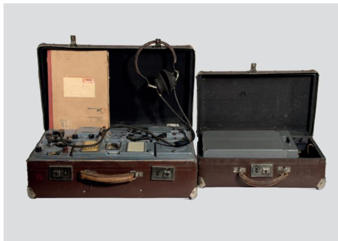
**Rarissime émetteur-récepteur radio clandestin du KGB (URSS) modèle P-57 code « RION » (1957), avec sa batterie/alimentation externe (en valises).** Le récepteur couvre une fréquence de 2 à 12 MHz. La fréquence de l'émetteur est variable de 2,5 à 10 MHz. Cet émetteur-récepteur provient du bureau du KGB de Riga, en Lettonie. Il a été acquis auprès du « Bunker KGB Museum » de Kaunas, en Lituanie.
